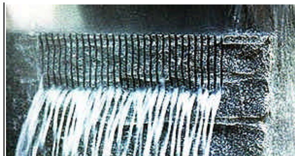
Figura 2- Corte de blocos de granitos com auxílio de lama abrasiva
